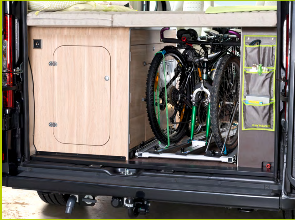
Ohne Umbau: Dank der Führungsschiene können Fahrräder auch bei aufgebaumem Bett bequem be- und entladen werden.
