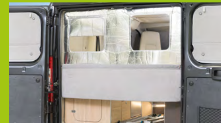
... und höhenverstellbarer Isoliereinsatz für den Heckbereich.
