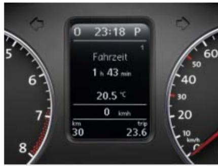
Auf der **Multifunktionsanzeige** lassen sich während der Fahrt relevante Informationen wie aktuelle und durchschnittliche Verbrauchswerte, Durchschnittsgeschwindigkeit, Reichweite, Fahrstrecke sowie Uhrzeit und Außentemperatur ablesen.
