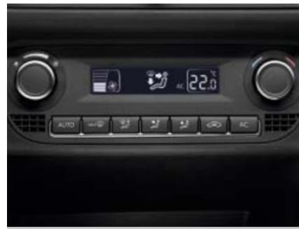
Die Klimaanlage „**Climatronic**“ mit elektronischer Regelung ermöglicht es, die gewünschte Temperatur immer konstant zu halten, und kühlt sogar das Handschuhfach. Ein integrierter Staub- und Pollenfilter mit Aktivkohleeinsatz hält schlechte Gerüche draußen.
