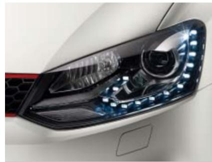
Die Bi-Xenon-Scheinwerfer mit integriertem LED-Tagfahrlicht und statischem Kurvenfahrlicht sorgen für optimale Sicht zu jeder Tageszeit. Sie sind zusammen mit der Kennzeichenbeleuchtung in LED-Technik für das hintere Nummernschild erhältlich.
