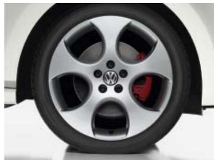
Die Leichtmetallräder „Denver“\* 7 J x 17 mit diebstahlsicheren Radschrauben gelten als Markenzeichen des Polo GTI. Die großzügigen Auslassungen erlauben einen Blick auf die rot lackierten Bremsättel.
