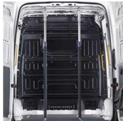
02 Zwei Spannstangen. Ermöglichen den sicheren Transport verschiedener Ladegüter. Zur flexiblen Positionierung im Laderaum lassen sich die Spannstangen schnell einsetzen und entnehmen. | KA | PL |
