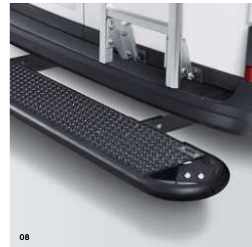
08 Stoßmindernde Trittstufe am Heck. Durch die Aufhängung mit Blattfedern können leichte Kollisionen einfach abgedefert werden. | KA | PL | PR | FG |
