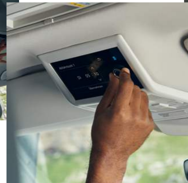
Am neuen Camper Bedienteil kann die Standheizung für die Nacht auf Dauerbetrieb eingestellt werden.
