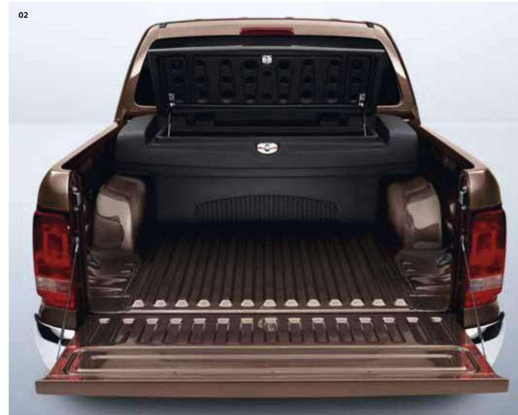
02 Werkzeugbox. Sie bietet jede Menge Platz für Ihr Werkzeug oder andere wichtige Utensilien, die unterwegs auf keinen Fall fehlen dürfen. Als optimaler Schutz vor Witterungseinflüssen wird die abschließbare Werkzeugbox über die gesamte Breite der Ladefläche zwischen den Radkästen montiert. Zwei Gasdruckfedern erleichtern das Öffnen sowie das Be- und Entladen der Box. | CL | HL | AV |
