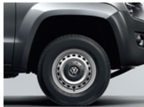
Die 16"-Stahlräder. Mit Reifen 205 R 16. Auch mit Winterbereifung erhältlich.
