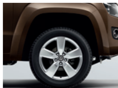
Die Leichtmetallräder „Aragonit“ 8 J x 19. Mit Reifen 255/55 R 19 XL. Die Serienbereifung wird beige packt.
