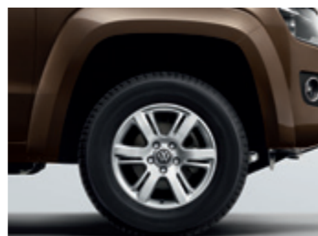
Die Leichtmetallräder „Aldo“ 8 J x 17, inklusive Radlaufverbreiterungen. Mit Reifen 245/65 R 17. Auch mit Winterbereifung erhältlich.
