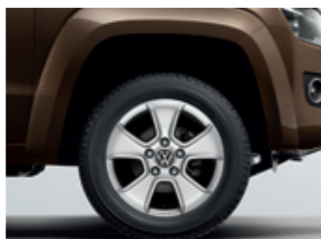
Die Leichtmetallräder „Amazonit“ 6½ J x 16. Mit 245/70-A/T-Geländebereifung. Nur in Verbindung mit den Offroad-Paketen als Beipack erhältlich.
