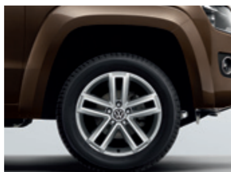
Die Leichtmetallräder „Cantera“ 8 J x 19, inklusive Radlaufverbreiterungen. Mit Reifen 255/55 R 19.
