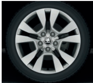
Leichtmetallfelgen Origami 7,0J x 17" mit polierter Oberfläche für 225/50-R17-Bereifung, optional für Ambition und Style (Yeti Outdoor).
