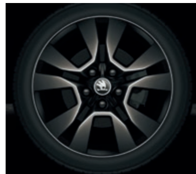
Leichtmetallfelgen Origami 7,0J x 17" in Schwarz mit 225/50-R17-Bereifung, Serie bei Monte Carlo (Yeti).
