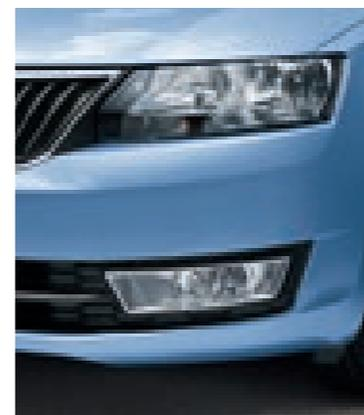
Die **Nebelscheinwerfer** mit integriertem Abbiegelicht leuchten den vorderen seitlichen Bereich des Fahrzeugs zusätzlich aus und kommen beim Abbiegen und Einparken mit einer Geschwindigkeit von bis zu 40 km/h zum Einsatz.
