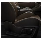
Sièges avant à réglages électriques 6 voies, massant et ventilés
