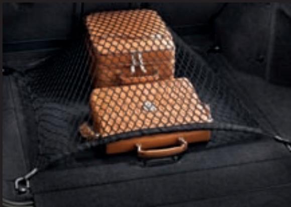
Ladungssicherungsnetz (Abb. oben) – VUB000700 Umfasst ein Netz für den Boden und zwei Spanngurte. Die Spanngurte sind ca. 2 Meter lang.
