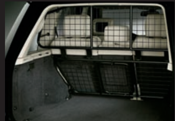
Gepäckraumabtrennung – volle Höhe VUB503890 Leicht zu entfernen. Mit praktischer Skidurchreiche. Kann dennoch mit einziehbarer Laderaumabdeckung ausgerüstet werden. Erfüllt die EG-Verordnung 17. Nicht kombinierbar mit Vertikaljalousie und starrem Laderaumschutz.
