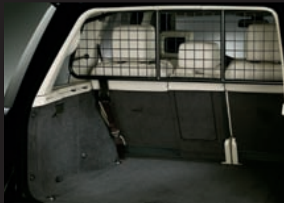
Gepäckraumabtrennung – halbe Höhe LR007320 Leicht zu entfernen. Gepäcksicherung gemäß EG-Verordnung 17.
