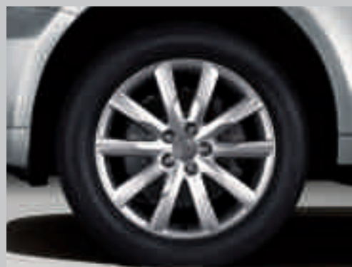
Aluminium-Gussräder im 10-Speichen-Design, Größe 8 J x 19 mit Reifen 235/55 R 19
