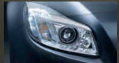
Neun Lichtfunktionen für jede Fahrsituation: das Adaptive Fahrlicht AFL+.
