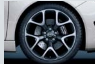
OPC Leichtmetallrad 8½ J x 20, Bi-Color, geschmiedet, glanzlackiert in Karbongrau, Speichenrand und Horn glanzveredelt, mit Reifen 255/35 R 20
