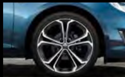
BiColor-Leichtmetallrad im „5-Doppelspeichen“-Design, 8 J x 19 mit Reifen 235/40 R 19 (PZT). (Optional)
