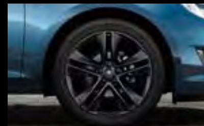
Leichtmetallrad im „5-Doppelspeichen“-Design in Hochglanzschwarz, 7½ J x 18 bzw. 8 J x 18 mit Reifen 225/45 R 18 bzw. 235/45 R 18 (RD9/PXR). (Optional, nicht für Limousine)
