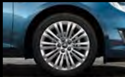
Leichtmetallrad im „10-Doppelspeichen“-Design, 7 J x 17 mit Reifen 215 (225)/50 R 17 (PXS). (Optional für Selection, Edition und INNOVATION)
