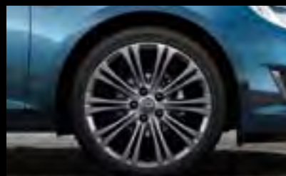
Leichtmetallrad im „10-Doppelspeichen“-Design, titanfarben, 8 J x 19 mit Reifen 235/40 R 19 (PZU). (Optional)
