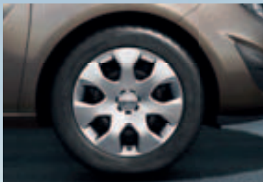
1 Stahlrad inkl. Abdeckung 6½ J x 15 und 6½ J x 16, Reifen 195/65 R 15 bzw. 205/55 R 16
