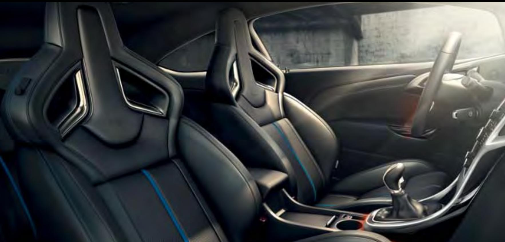
**1. Elektropneumatische Seitenpolster.** Die OPC High-Performance-Sitze bieten optimalen Seitenhalt und Komfort für Fahrer und Beifahrer durch die individuelle Einrastung der Seitenpolster per Knopfdruck.
