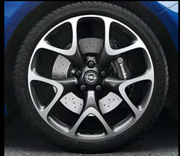
Leichtmetallrad. 8½ J x 20 im 5-Y-Speichen-OPC Design, BiColor, Reifen 245/35 R 20 (R01, Option).
