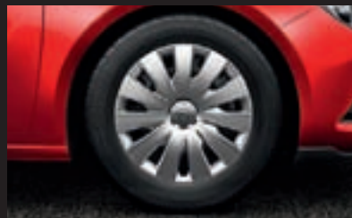
Stahlrad inkl. Abdeckung, 7 J x 17 mit Reifen 235/55 R 17. (PWP) Serie bei Edition
