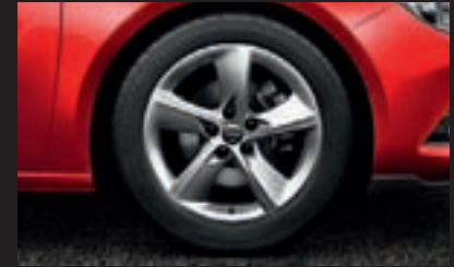
Leichtmetallrad im „5-Speichen“-Design, 7½ J x 18 mit Reifen 235/50 R 18. (RSZ) Serie bei BiTurbo
