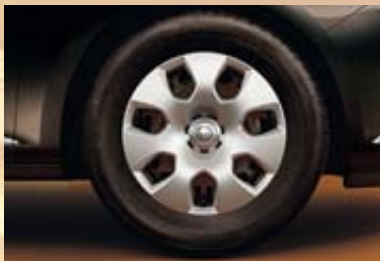
1 Stahlrad inkl. Abdeckung 6½ J x 16, Reifen 205 (215)/60 R 16 (PWM).
