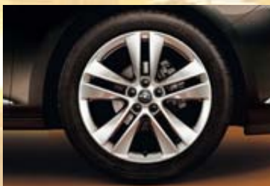
5 Leichtmetallrad 7½ J x 18 bzw. 8 J x 18 im 5-Doppelspeichen-Design, Reifen 225/45 R 18 bzw. 235/45 R 18 (PZV/PZJ).
