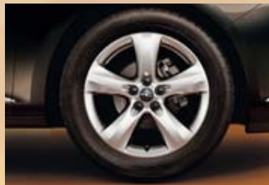
3 Leichtmetallrad 7 J x 17 im 5-Speichen-Design, Reifen 215 (225)/50 R 17 (PWX).
