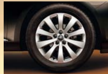
4 Leichtmetallrad 7 J x 17 im 10-Speichen-Design, Reifen 215 (225)/50 R 17 (PGQ).
