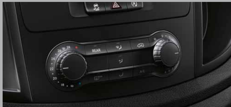
Die TEMPMATIC regelt automatisch die gewünschte Temperatur für Fahrer und Beifahrer.
