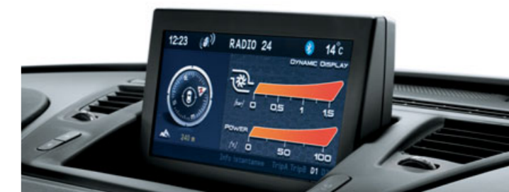
Il Radio NAV visualizza la pressione del turbocompressore e la potenza erogata in %.
