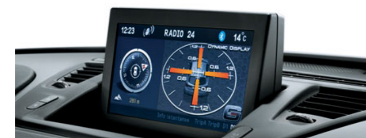
Il Radio NAV visualizza anche il valore dell'accelerazione (longitudinale e laterale) a cui è sottoposta la vettura.
