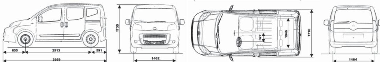
Dimensions en mm. NB : Option barres de toit : hauteur 1 803 mm. Version Trekking : hauteur 1 810 mm.
