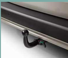
ATTELAGE AVEC ROTULE DÉMONTABLE SANS OUTILS
