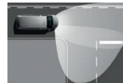
Das **Abbieglicht** der Nebelscheinwerfer leuchtet beim Abbiegen den kurveninneren Straßenrand aus, wenn Sie 40 km/h oder langsamer fahren. So erkennen Sie mögliche Gefahren schneller und kommen sicher ans Ziel.
