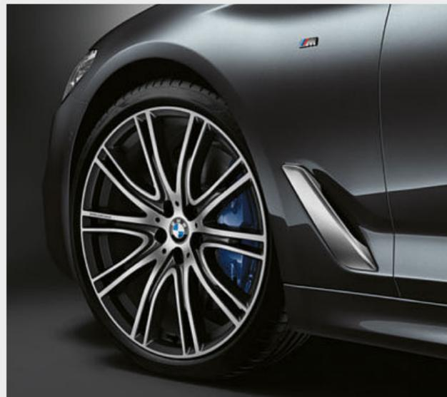
□ 20" BMW Individual Leichtmetallräder V-Speiche 759 I Orbitgrau glanzgedreht, mit Mischbereifung und Notlaufeigenschaften, Radgröße vorn 8J x 20, Bereifung 245/35 R20, Radgröße hinten 9J x 20, Bereifung 275/30 R20.
