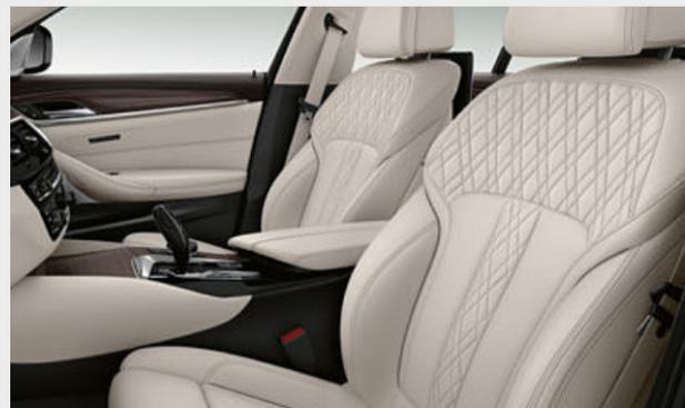
□ Die Komfortsitze für Fahrer und Beifahrer inkl. aktiver Kopfstützen sind vielfach elektrisch verstellbar. So lassen sich das obere Lehnensegment, die Lehnenbreite, die Oberschenkelauflage und die Kopfstützenhöhe individuell anpassen. Der Ausstattungsumfang umfasst zudem die Lordosenstütze und die Memory-Funktion für Fahrer und Beifahrer.
