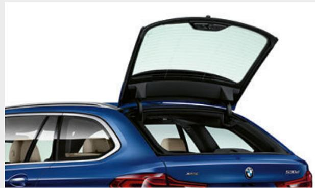
■ Die Heckscheibe lässt sich zum Ablegen oder Herausnehmen von Gepäck mit dem Fahrzeugschlüssel per Knopfdruck separat öffnen. Besonders praktisch: Beim Öffnen fährt das Abdeckrollo selbstständig hoch und beim manuellen Schließen der Heckscheibe deckt es den Gepäckraum automatisch wieder ab.
