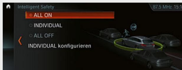
□ Der Driving Assistant Plus<sup>1</sup> bietet mehr Komfort und Sicherheit in monotonen oder unübersichtlichen Fahrsituationen wie Stau, bei stockendem Verkehr oder langen Fahrten in der Stadt, über Land oder auf Autobahnen sowie an Kreuzungen oder bei Spurwechseln. Dies wird z. B. über die Aktive Geschwindigkeitsregelung mit Stop&Go-Funktion ermöglicht, die permanent die gewünschte Geschwindigkeit bis 210 km/h und den Abstand zum vorausfahrenden Fahrzeug hält.
