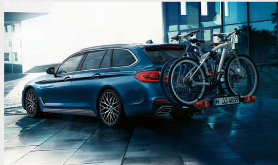
○ Der **Fahrradheckträger Pro 2.0** ist leicht, aber dennoch stabil und mit bis zu 60 kg belastbar. Er bietet eine herausragende einfache Handhabung und kann zwei Fahrräder/E-Bikes transportieren (auf drei Räder erweiterbar). Dabei ermöglicht seine Abklappfunktion jederzeit einfachen Zugang zum Gepäckraum.
