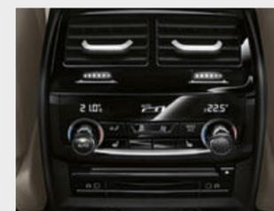
□ Die Klimaautomatik mit 4-Zonenregelung ermöglicht individuellen Klimakomfort für Fahrer und Beifahrer sowie für die beiden Fondpassagiere rechts und links.
