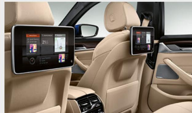
□ Die Ausstattung Fond-Entertainment Professional<sup>2</sup> umfasst zwei unabhängige 10,2"-Farb-Bildschirme (neigungsverstellbar) und ein Blu-ray-Laufwerk. Dies ermöglicht während der Fahrt Navigation und Internetnutzung (bei bestehendem Mobilfunkvertrag); Steuerung per Fernbedienung, Anschlüsse für MP3-Player, Spielekonsolen und Kopfhörer (auch kabellos).
