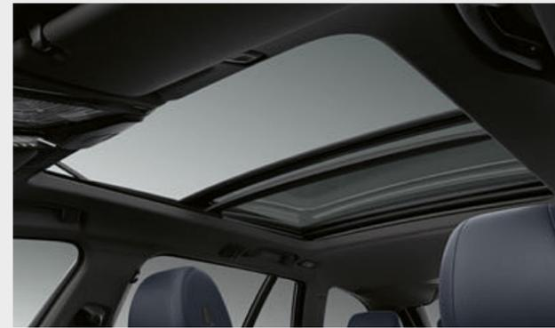
□ Das Panorama-Glasdach bietet geöffnet viel frische Luft und sorgt auch geschlossen für eine freundliche, lichtdurchflutete Atmosphäre im Fahrzeuginnenraum. Es öffnet und schließt sich auf Knopfdruck oder per Fernbedienung vollautomatisch und ist mit Schiebe- und Hebefunktion sowie Sonnenschutzrollo und Windabweiser ausgestattet.
