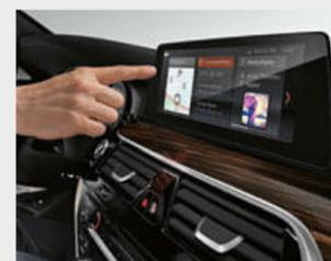
□ Navigationssystem Professional mit Radio Professional inkl. DVD-Laufwerk, Bedienung über Touch Display oder iDrive Touch Controller.
