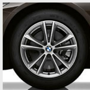
□ 17" Leichtmetallräder V-Speiche 631 Ferricgrau glanzgedreht, Radgröße 7,5J x 17, Bereifung 225/55 R17.
