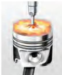
**Die Piezo-Injektoren** öffnen und schließen sich innerhalb von Bruchteilen von Millisekunden und spritzen mehrmals mit bis zu 2.000 bar in den Brennraum ein. Bei einem Einspritzvorgang werden teilweise winzigste Mengen von weniger als einem tausendstel Gramm eingespritzt.
