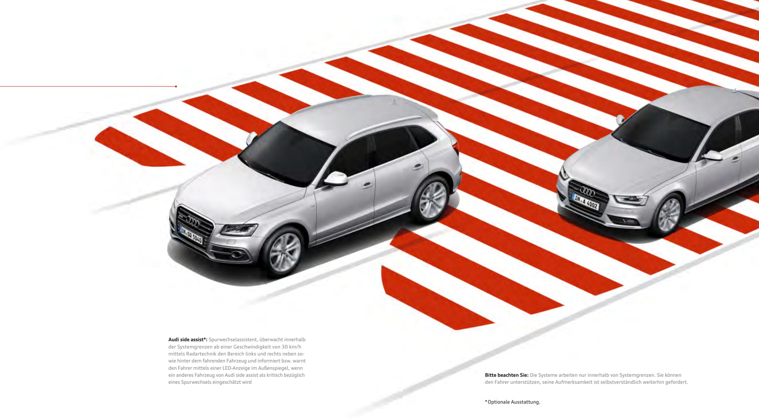
**Audi side assist\***: Spurwechselaassistent, überwacht innerhalb der Systemgrenzen ab einer Geschwindigkeit von 30 km/h mittels Radartechnik den Bereich links und rechts neben sowie hinter dem fahrenden Fahrzeug und informiert bzw. warnt den Fahrer mittels einer LED-Anzeige im Außenspiegel, wenn ein anderes Fahrzeug von Audi side assist als kritisch bezüglich eines Spurwechsels eingeschätzt wird
