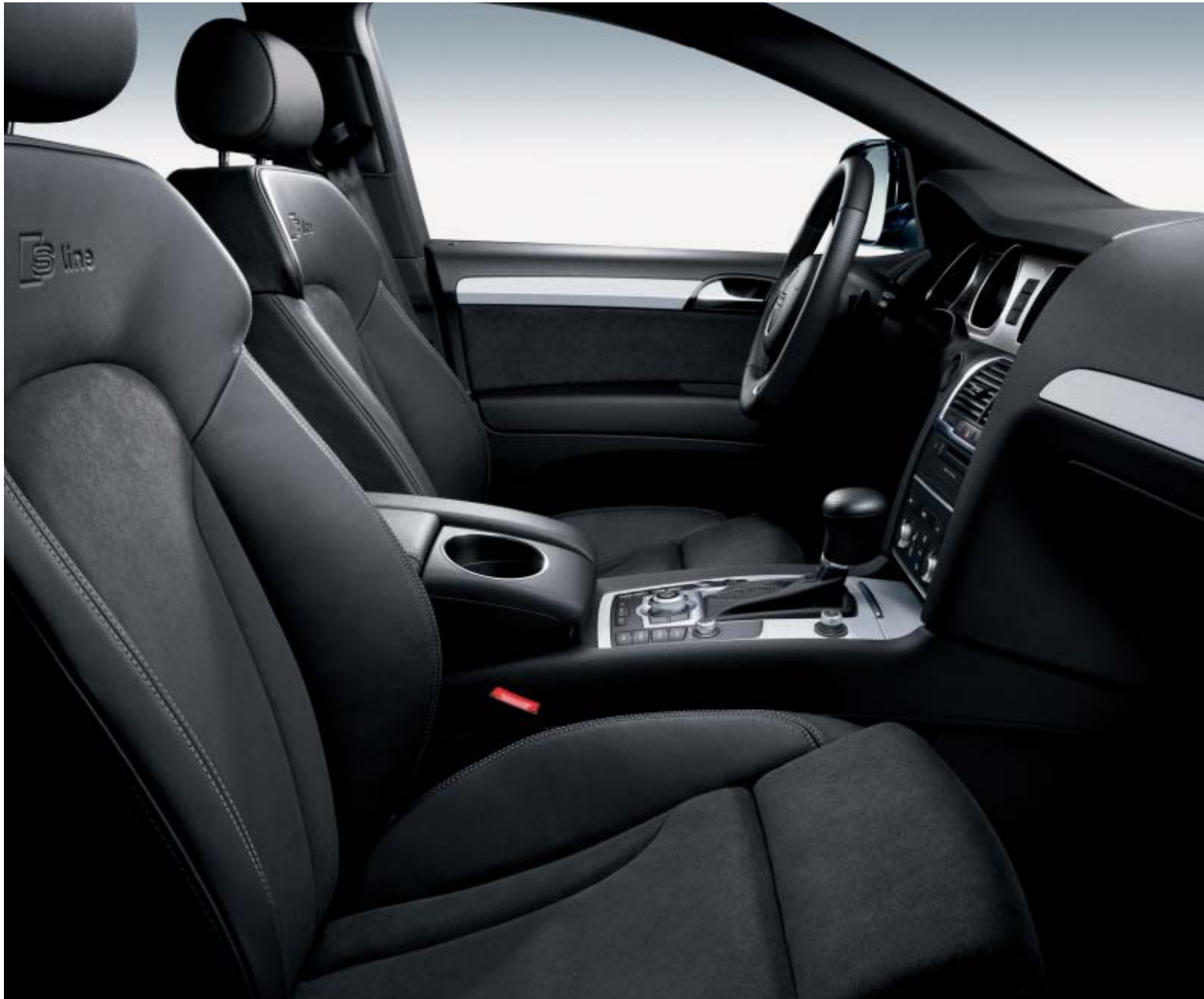
Sichtbar ergonomisch: Sportsitze mit Bezügen aus Alcantara/Leder mit Kontrastnähten und S line-Schriftzügen in den Vordersitzlehnen, Dekoreinlagen in Aluminium matt gebürstet
