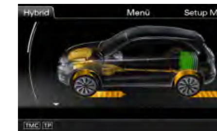
Kombiniertes Fahren im Hybrid-Modus mit Verbrennungs- und Elektromotor
