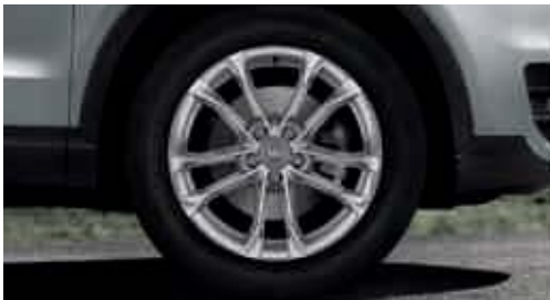
Aluminium-Gussräder im 5-Doppelspeichen-Design Größe 7 J x 18 mit Reifen 235/50 R 18
