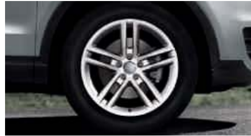
Aluminium-Gussräder Audi exclusive im 5-Doppelspeichen-Design Größe 7 J x 18 mit Reifen 235/50 R 18. Ein Angebot der quattro GmbH
