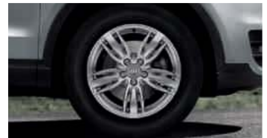
Aluminium-Gussräder im 5-Arm-Triax-Design Größe 7 J x 17 mit Reifen 235/55 R 17
