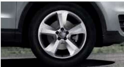
Aluminium-Gussräder Audi exclusive im 5-Arm-Offroad-Design Größe 7 J x 18 mit Reifen 235/50 R 18. Ein Angebot der quattro GmbH
