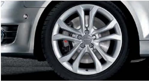
Aluminium-Gussräder im S Design, Größe 7,5 J x 18 mit Reifen 225/40 R 18
