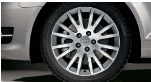
Aluminium-Gussräder im 16-Speichen-Design, anthrazit, teilpoliert, Größe 7,5 J x 17 mit Reifen 225/45 R 17 (wahlweise mit Reifen mit Notlauf- eigenschaften)
