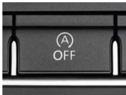
Das Start-Stopp-System steht für sparsames und schadstoffarmes Fahren. Beim Halten im Stau oder an einer Ampel reicht es, die Kupplung zu lösen und den Gang herauszunehmen, und der Motor schaltet sich aus. Zum Weiterfahren kuppeln Sie einfach wieder ein.
