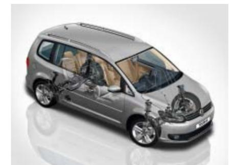
Die **adaptive Fahrwerksregelung DCC** stellt innerhalb von Millisekunden jeden Dämpfer individuell auf die Fahrbahn und die Fahr situation ein. Per Knopfdruck entscheiden Sie, wie straff oder komfortabel das zehn Millimeter tiefergelegte Fahrwerk eingestellt sein soll.
