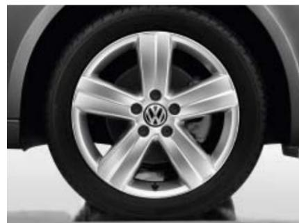
Das Leichtmetallrad „Oakland“\* mit 225er Reifen und Felgen im Format 7 J x 17 ist durch Radsicherungen effektiv vor Diebstahl geschützt.
