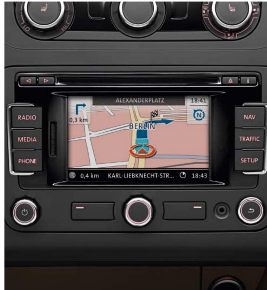
Das **Radio-Navigationssystem „RNS 315“** mit CD-Laufwerk und MP3-Wiedergabefunktion hat ein als Touchscreen steuerbares Farbdisplay mit übersichtlicher Kartenavigation sowie eine praktische AUX-IN-Buchse für den Anschluss von externen Audiogeräten wie beispielsweise einem MP3-Player. Des Weiteren verfügt es über einen Schacht zum Einlesen von SD-Karten.
