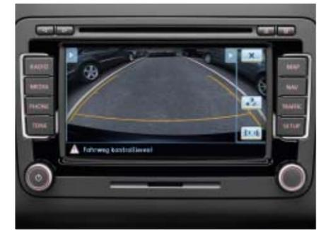
Auf dem Radiodisplay wird das Bild der **Rückfahrkamera „Rear Assist“** wiedergegeben. Durch freie Sicht hinter das Fahrzeug ist so besseres und einfacheres Einparken möglich. Auch das Ankuppeln eines Anhängers wird dadurch erleichtert.
