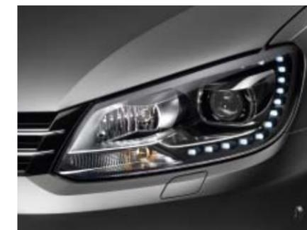
Die **Bi-Xenon-Scheinwerfer** verfügen über ein dynamisches Kurvenfahrlicht und ein LED-Tagfahrlicht. Je nach Geschwindigkeit passt sich die Lichtverteilung mittels Motoren in den Scheinwerfern an die Fahrt auf der Landstraße oder der Autobahn an.
