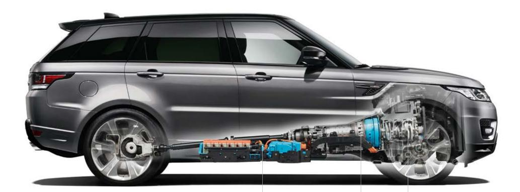
HIGH VOLTAGE BATTERY INVERTER PACKAGE TRANSMISSION WITH V6 DIESEL INTEGRATED 35kW ENGINE ELECTRIC MOTOR
