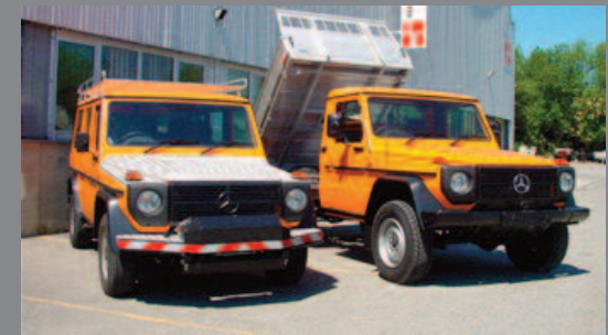
G-Klasse Fahrgestell/Fahrerhaus und Kipperaufbau.
