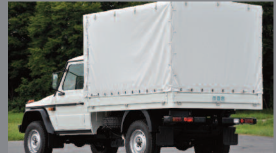
G-Klasse Fahrgestell/Fahrerhaus mit Pritsche, Spriegel und Plane.
