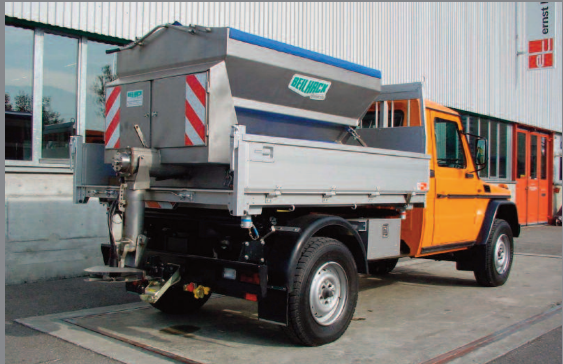
Die G-Klasse mit speziellem Aufbau als Winterstreufahrzeug für kommunale Arbeitseinsätze.
