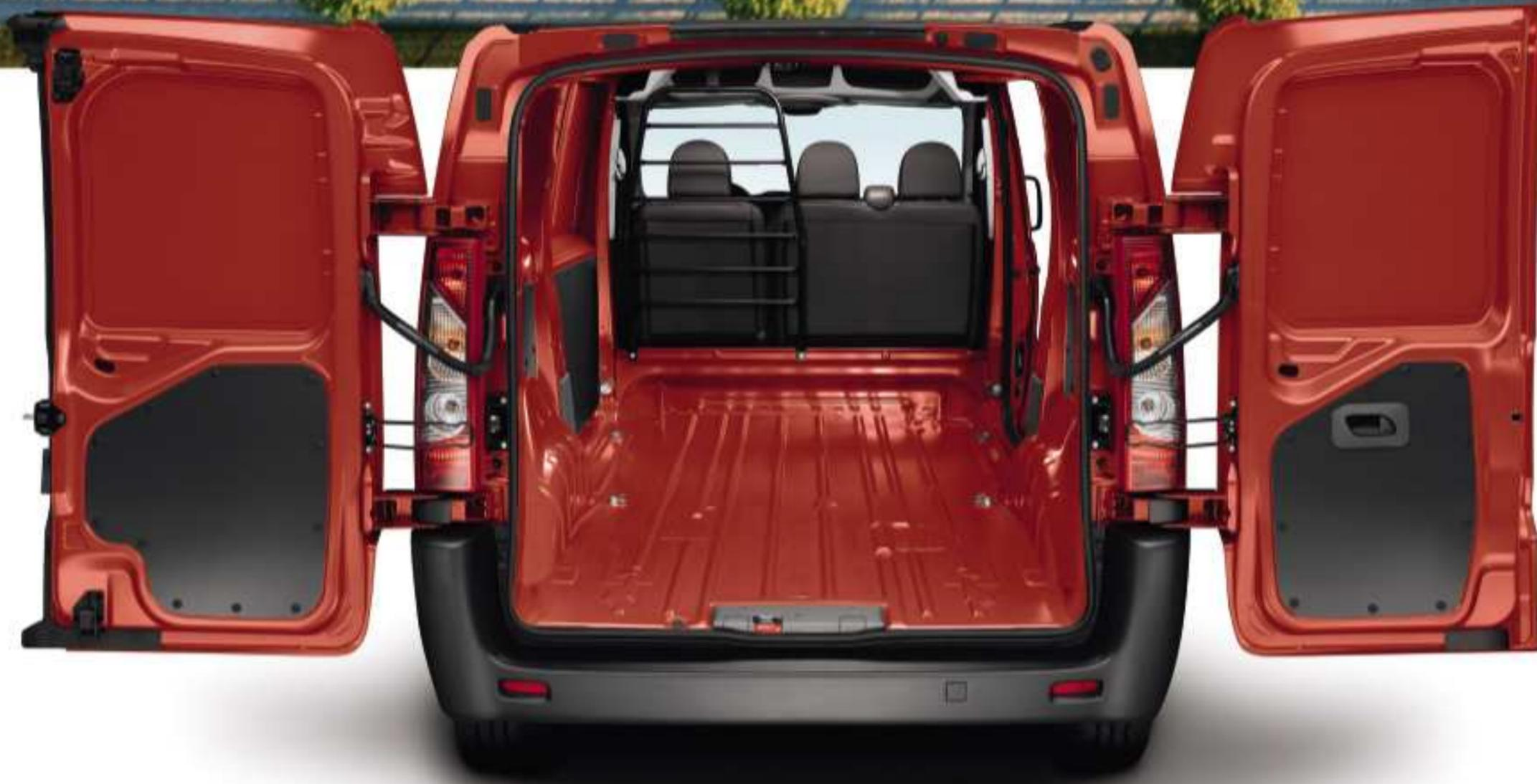
Die hinteren Flügeltüren (mit oder ohne Verglasung) lassen sich auf 90° und dank eines versenkbaren Systems sogar bis auf 180° öffnen. Die Scheiben der Hecktüren können mit Heckscheibenheizung und Heckscheibenwischern ausgestattet werden.
