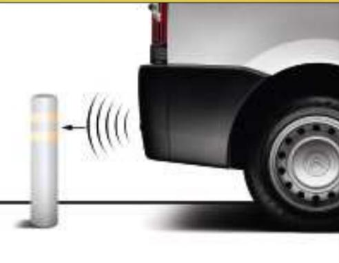
Die optionale Einparkhilfe hinten macht das Rückwärtsfahren deutlich sicherer. Über 4 Sensoren im hinteren Stoßfänger werden Hindernisse jederzeit erkannt und durch ansteigende Hinweistöne angezeigt. Ab 30 cm ertönt ein permanenter Warnton.
