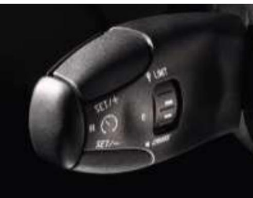
Mit dem für alle Modelle erhältlichen Geschwindigkeitsregler können Sie die Geschwindigkeit beibehalten, ohne das Gaspedal zu betätigen. Der Geschwindigkeitsbegrenzer verhindert das Überschreiten einer individuell wählbaren Höchstgeschwindigkeit. Bei Betätigen des Gaspedals über einen Widerstand hinaus oder bei Drücken des Schalters wird das System deaktiviert. Das Treten des Bremspedals beendet die Programmierung.
