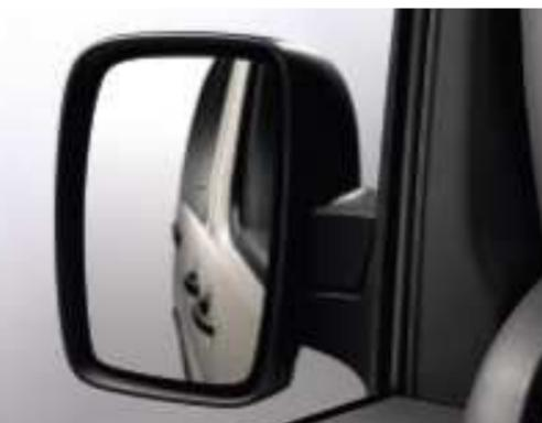
Als Option können die Außenspiegel des Citroën Jumpy auch elektrisch verstellt und komplett eingeklappt werden. Auf Wunsch lässt sich außerdem das Beheizen der Außenspiegel über die Heckscheibenheizung steuern.
