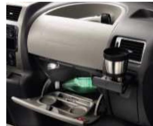
Bereits in das Armaturenbrett sind zahlreiche Staufächer integriert. Ein abschließbares und beleuchtetes Handschuhfach (bei den Modellen mit Klimaanlage auch mit Kühlfunktion), eine große Ablagemulde auf dem Armaturenbrett und einklappbare Getränkehalter außen. Im unteren Bereich des Armaturenbretts findet man je nach Version offene oder geschlossene Staufächer und ein zusätzliches Ablagefach direkt unter dem Lenkrad. Der Citroën Jumpy hat wirklich einen ausgeprägten Sinn für Ordnung!
