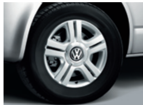
Vier Leichtmetallräder „L.A.“ 7 J x 16. Mit Reifen 235/60 R16.
