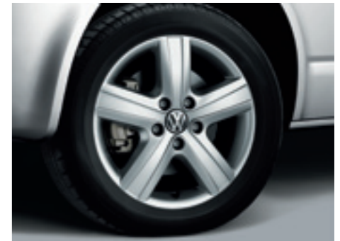
Vier Leichtmetallräder „Thunder“ 7 J x 17. Mit Reifen 235/55 R17. Sie sind Serie beim Comfortline mit 132-kW-Motor* und beim Comfortline mit 103-kW-Motor* und 4MOTION.
