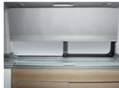
Die Verdunkelung im Wohnraum . Aus der Dachrahmenverkleidung lassen sich Rollos ziehen, die an den Fensterholmen blickdicht abschließen. Zur Abdunkelung des California Beach werden Stoffvorhänge mit eingnähten Magneten verwendet.
