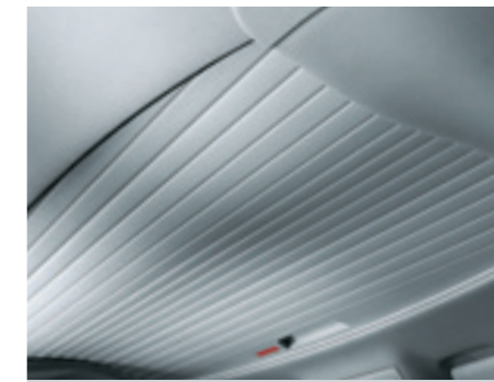
Das Lamellenrollo . Die Auf- und Abstiegsöffnung vom Fahrerhaus zur Liegefläche oben wird bei Nichtgebrauch mit einem Lamellenrollo verschlossen.
