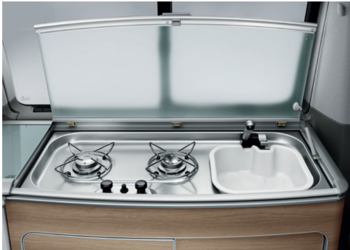
Die Koch-Spül-Kombination . Der 2-Flammen-Gaskocher mit Piezo-Zündung befindet sich links neben dem Edelstahlspülbecken mit herausnehmbarer Spülschüssel. Beides ist mit einer Glasabdeckung versehen. Die Wasserversorgung entspricht der Richtlinie DIN 2001-2.
