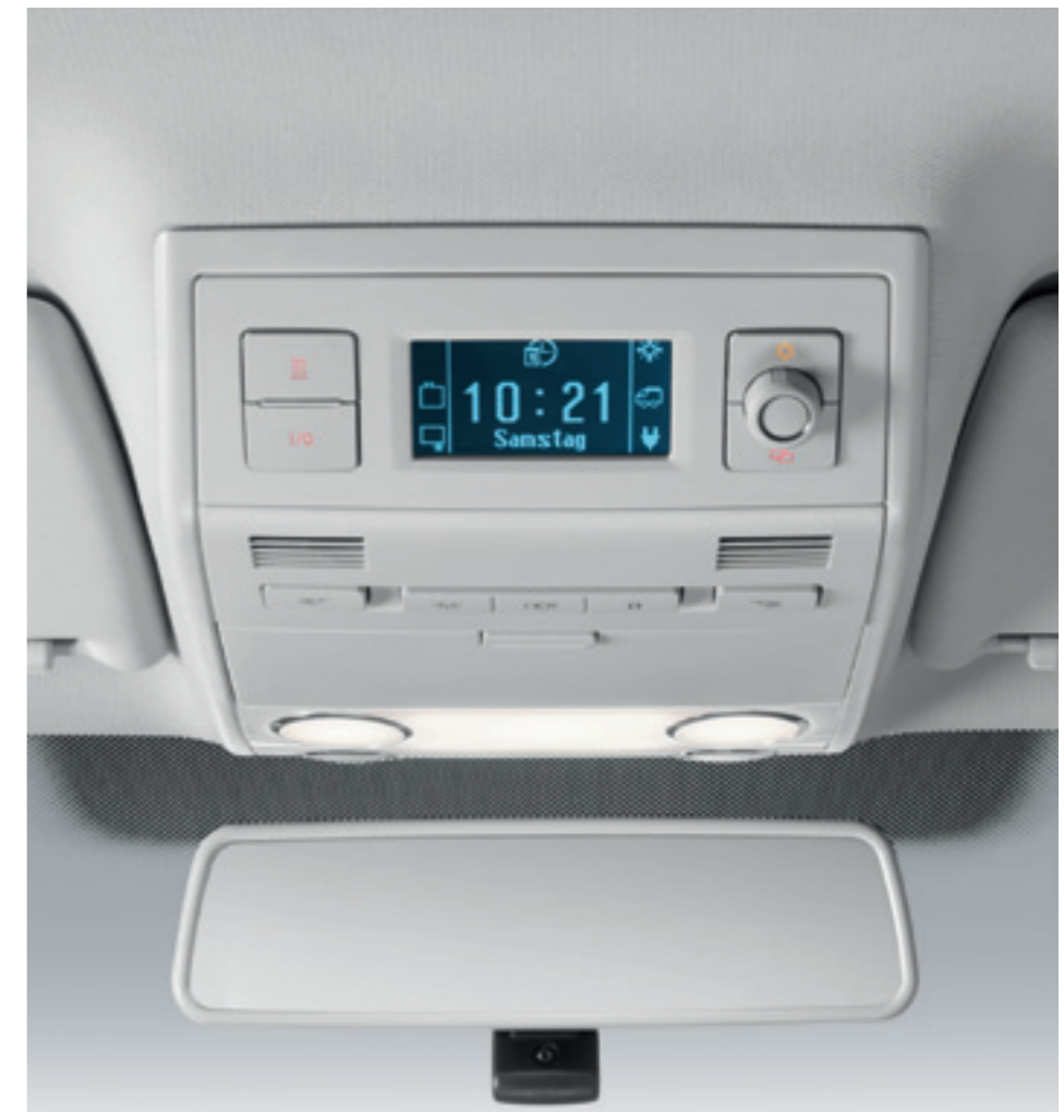
Das zentrale Bedienfeld . Über dem Innenspiegel platziert, verfügt es über ein LC-Display für die Außentemperatur, den Batterieladezustand, den 230-V-Anschluss, den Betriebszustand der Kühlbox und den Füllstand von Frisch- und Abwassertank. Die Standheizung lässt sich ebenfalls über das Bedienfeld steuern; sie arbeitet unabhängig von der Heizungs- und Belüftungsanlage und ist auch über die Funkfernbedienung aktivier- bzw. deaktivierbar.
