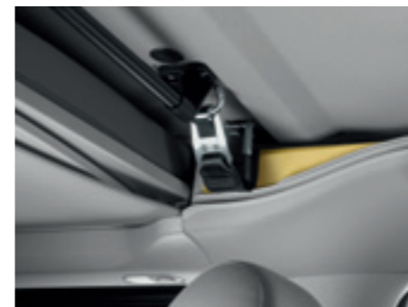
Das manuelle Aufstelldach . Während der Fahrt ist das Aufstelldach sicher in zwei Halterungen verankert. Am Urlaubsort kann es mit wenigen Handgriffen hochgestellt werden. Damit wächst der California Beach auf 1,98 m Stehhöhe.
