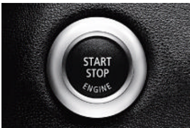
■ Start-/Stop-Knopf zum Starten des Motors. □ Komfortzugang ermöglicht das Öffnen und Schließen des Fahrzeugs, ohne die Funkfernbedienung in die Hand zu nehmen. Der Motor kann zudem schlüssellos gestartet werden. Öffnen und Schließen des Verdecks mit Funkfernbedienung.
