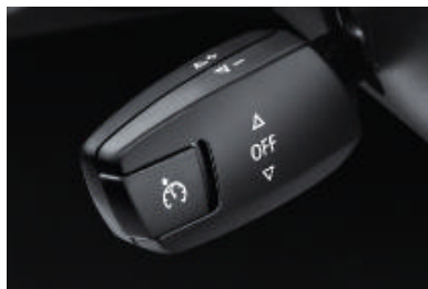
□ Geschwindigkeitsregelung speichert ab ca. 30 km/h die gewünschte Geschwindigkeit und hält sie konstant (Betätigung über den Lenkstockhebel links). Nach einer Beschleunigung erreicht das Fahrzeug automatisch wieder die ursprünglich gespeicherte Geschwindigkeit. Durch Bremsen wird die Funktion außer Kraft gesetzt.
