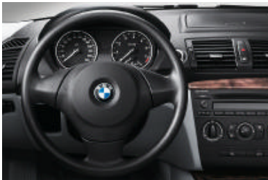
■ Serienlenkrad (Durchmesser 375 mm), drei Speichen.
